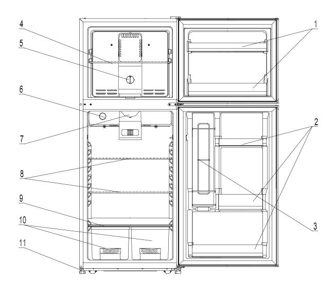
1.FREEZER BIN 2.REFRIGERATOR BIN **3.CAN DISPENSER 4.FREEZER SHELF** 5.FREEZER TEMPERATURE CONTROL KNOB 11.LEVELING LEG 6.REFRIGERATOR TEMPERATURE CONTROL KNOB
