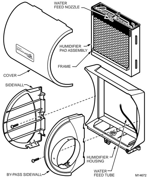
**Fig. 4. Humidifier components.**
