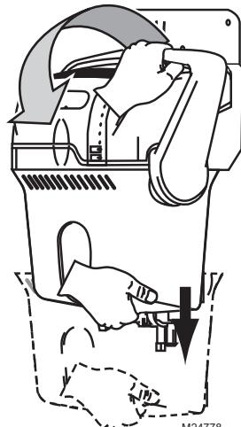
5. Utiliser l'eau du robinet pour enlever les dépôts minéraux qui se détachent du réservoir. Le tamis au bas du réservoir est amovible. Pour un bon nettoyage, faire tremper le réservoir dans de l'eau chaude savonneuse, puis bien le rincer. Le réservoir se nettoie aussi au lave-vaisselle.
