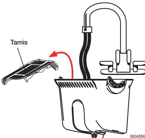
6. Enlever soigneusement les dépôts minéraux qui recouvrent l'élément chauffant et les parois du réservoir. On peut utiliser des tampons à récurer les casseroles à revêtement antiadhésif pour frotter les parois et les parties internes du réservoir.
