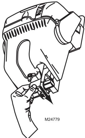
4. Saisir fermement le bas du réservoir. Pousser vers le bas le bouton de sécurité du couvercle du réservoir. Tirer la poignée de verrouillage vers l'avant pour dégager le réservoir. **Remarque :** La poignée de verrouillage n'est pas fixée au réservoir lors du retrait de ce dernier.
