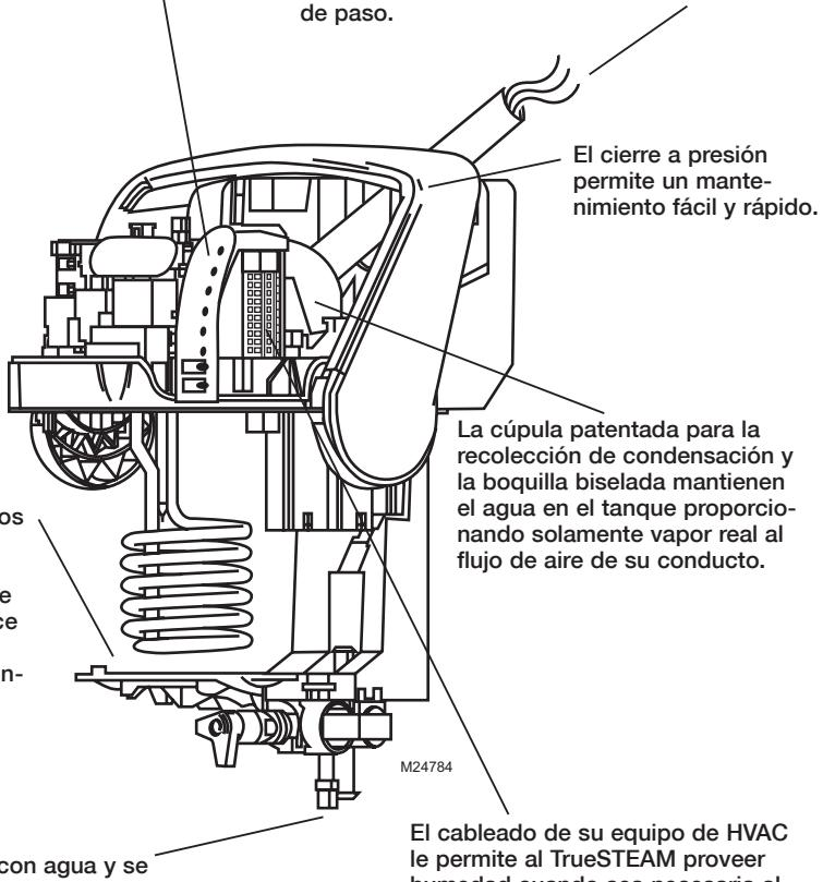
Se llena con agua y se drena automáticamente cuando es necesario de manera que no tiene que recordar cuándo hacerlo.
