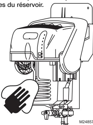
Une fois le réservoir nettoyé, le replacer en le verrouillant. Fixer le robinet de sectionnement d'eau à l'arbre de la came et le verrouiller. Le voyant PRESS RESET (Appuyer sur RÉARMEMENT) clignotera au démarrage. Appuyer sur le bouton RESET (RÉARMEMENT) pour mettre l'humidificateur en état de fonctionner.
