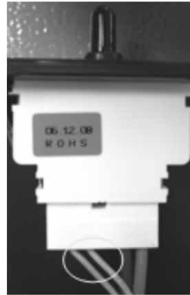
CONNECTOR 9 R- DOOR S/W BO, PK PIN 3&4
