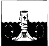
une action continue de culbtage qui fournit un nettoyage en profondeur de la charge à laver.
