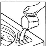
liquide de blanchiment chloré mesurée dans le distributeur de liquide de blanchiment chloré. Le liquide de blanchiment sera dilué automatiquement au cours de la partie de lavage du programme.
