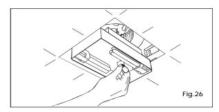
Change the fluorescent lamps (Panasonic FDS 18E27/4, 18W or FDS18E35/4, 18W or FDS18E42/4, 18W) or the 4W night lamp, connect the plug connector II and replace the grille. (Fig.27)
