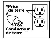
Cet appareil est destiné à un circuit de 120V et est muni d'une fiche de mise à la terre semblable à celle illustrée par le croquis A de la figure "A". S'assurer que l'appareil est branché à une prise de courant ayant la même configuration que la fiche. Aucun adaptatteur ne devrait être utilisé avec cet appareil.
