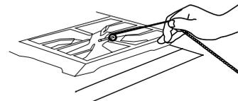
5. Pour le brûleur le plus proche de l'allumette, enfoncer et faire tourner le bouton du brûleur jusqu'à la position LITE/HI. Le brûleur s'allume immédiatement. Lorsque le brûleur est allumé, tourner le bouton jusqu'au réglage désiré.
