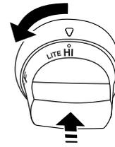
4. On doit constater l'allumage de l'allumeur. Lorsque le brûleur est allumé, lâcher le bouton; tourner le bouton de commande au réglage désiré.
