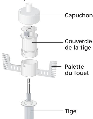
1. Placer la tige du fouet à oeufs sur l'axe du socle. Tourner lentement la tige jusqu'à ce qu'elle s'enclenche sur l'axe.
