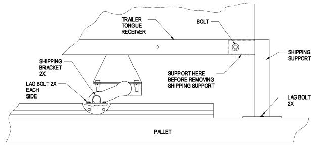
NOTE: BLOCK GRILL SECURELY BEFORE REMOVING THE SHIPPING SUPPORT AND INSTALLING THE TRAILER TONGUE.
