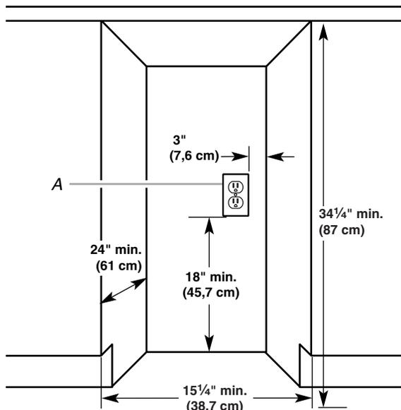
A. Prise électrique reliée à la terre qui doit être à une distance minimum de 3" (7,6 cm) des armoires voisines ou des murs latéraux tel qu'illustré. Elle peut être placée du côté droit ou du côté gauche du produit.
