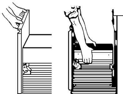
4. Placer les 2 autres cornières de protection sur le plancher, près du compacteur. Saisir les côtés de la caisse du compacteur et placer le compacteur sur le côté, sur les cornières de protection. Retirer la base placée au fond du compacteur avant l'expédition.
