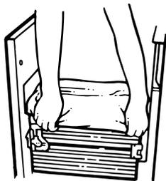
2. Immobiliser le sac en engageant les 4 trous pré-perçés sur les boutons de retenue du sac. Les trous s'agrandiront sur les boutons sans endommager le sac.
