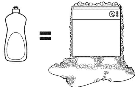
**NOTE :** utiliser un détergent qui n'est pas spécifiquement conçu pour les lave-vaisselles remplira l'appareil de mousse. Pendant le nettoyage, cette mousse débordera des événements du lave-vaisselle, tombera sur le plancher de la cuisine qui deviendra mouillé.
