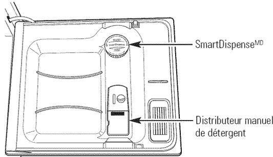
Le couvercle du distributeur manuel s'ouvre pendant le cycle de lavage. Si vous utilisez SmartDispense<sup>MD</sup>, laissez ouvert le couvercle du distributeur manuel avant de commencer le cycle.
