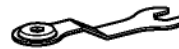
Clé (pour retirer les boulons d'expédition et ajuster les pieds de nivellement)
