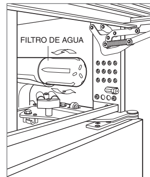
Extracción del filtro de agua
