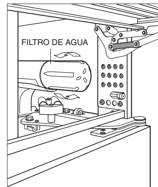
Extracción del filtro de agua
