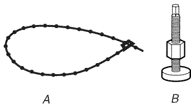
A. Attache de fixation perlée B. Pieds de nivellement avant avec écrous (2)
