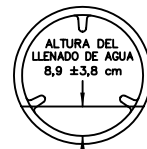
SIN CARGA, POSICIÓN DE ARRANQUE DEL CICLO PARA TALAS DE PLANCHADO PERMANENTE.
