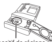
Dispositif de réglage du produit de rinçage
