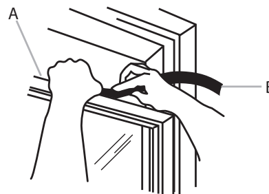
A. Parte superior del bastidor de la ventana inferior B. Sello de espuma
