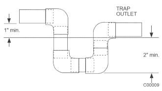
Fig. 8—Condensate Trap
