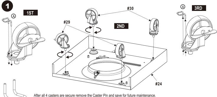
Après avoir fixé les quatre roulettes, enlevez la dispositif de blocage pour roulette et conservez-la pour toute réparation future. Una vez debidamente instaladas las cuatro ruedas, retire la clavija para la rueda y guárdela para emplearla en el futuro, cuando deba dar servicio de mantenimiento al aparato.
