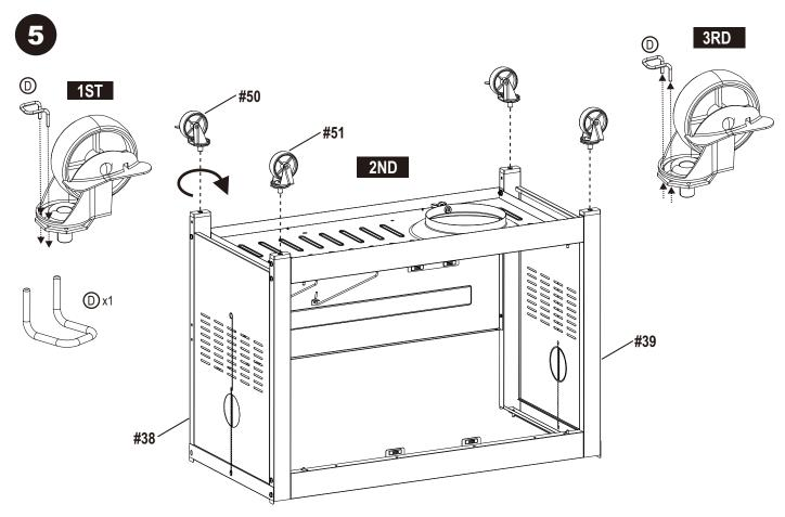
After all 4 casters are secure remove the Caster Pin and save for future maintenance. Après avoir fixé les quatre roulettes, enlevez la dispositif de blocage pour roulette et conservez-la pour toute réparation future.
