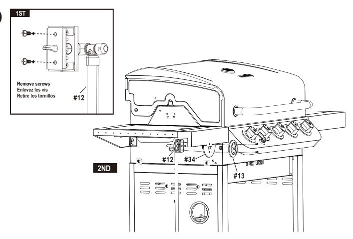
Secure using screws that were removed from sideburner valve bracket. Fixez le tout au moyen des vis enlevées du support de valve du brûleur latéral. Fíjelo con los tornillos que retiró del soporte de la válvula del quemador lateral.
