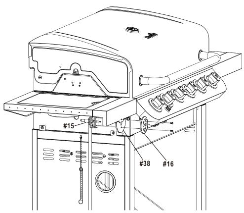
Secure using screws that were removed from sideburner valve bracket. Fixez le tout au moyen des vis enlevées du support de valve du brûleur latéral. Fíjelo con los tornillos que retiró del soporte de la válvula del quemador lateral.
