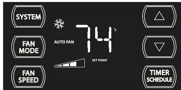
AUTO FAN (Cooling Demand)
