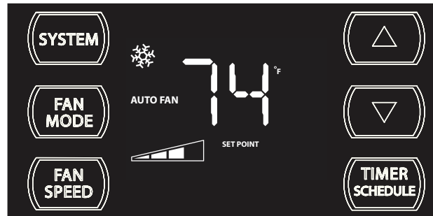
AUTO FAN (Cooling Demand)
