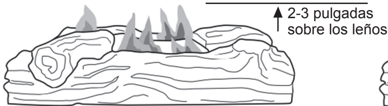
Fig. 22 - Patrón correcto de la llama del quemador
