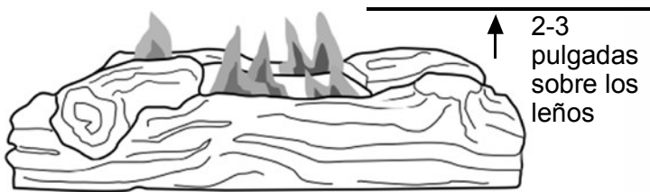
Fig. 22 - Patrón correcto de la llama del quemador
