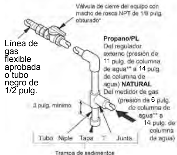
Fig. 10 - Conexión del gas
