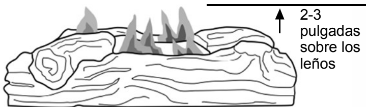
Fig. 22 - Patrón correcto de la llama del quemador
