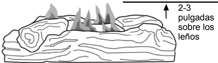
Fig. 22 - Patrón correcto de la llama del quemador
