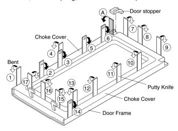
Figure C-3. Door Disassembly
