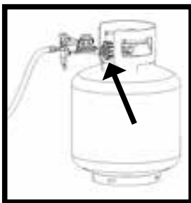
Aplique la solución a la válvula del cilindro de gas.
