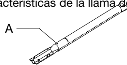
A. Tornillo de ajuste del obturador de aire
