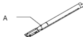
A. Vis de réglage de l'admission d'air
