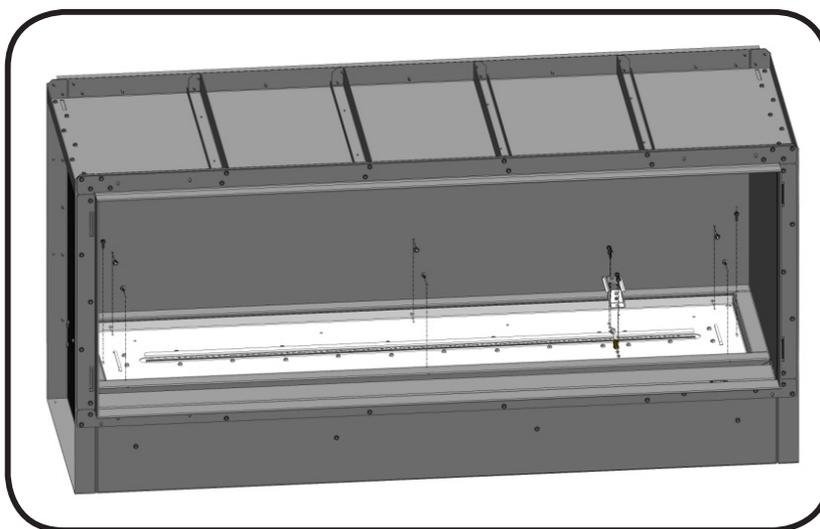
Soulevez le plateau à braises du foyer; en poussant par le haut, dégagez le thermocouple et l'allumeur du plateau à braises.
