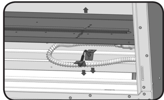
4. Débranchez le raccord flexible en acier inoxydable de l'injecteur à l'aide de deux (2) clés.
