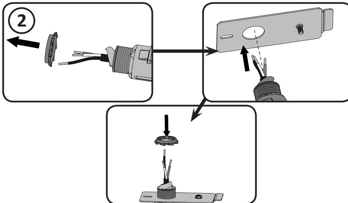
Branchez le fil vert de mise à terre à la plaque de jonction à l'aide de la vis de mise à terre (W570-0098). À l'aide de connecteurs de fils, branchez ensemble les fils blancs neutres, puis les fils noirs chargés.
