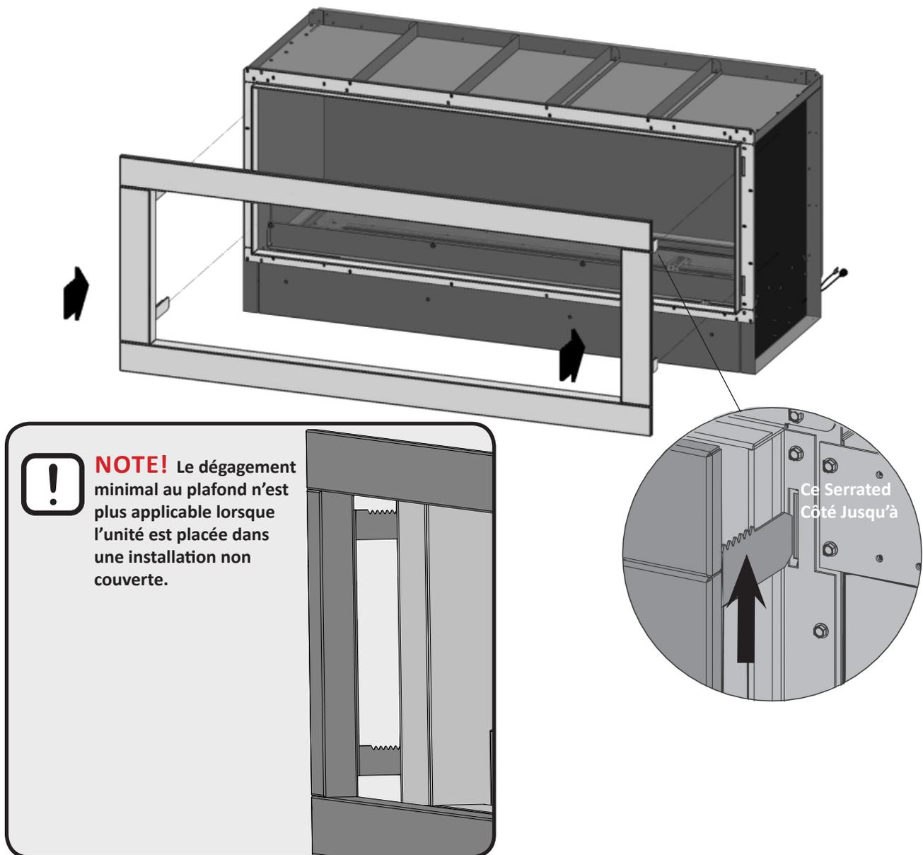
5. Desserrez les vis de serrage et descendez-les jusqu'à ce qu'elles s'arrêtent. Resserrez les vis de serrage et fermez la porte d'accès.
