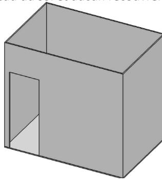
Installation à l'intérieur d'une enceinte partielle qui comprend un recouvrement sur le dessus et deux murs latéraux au maximum. Ces murs peuvent être parallèles l'un par rapport à l'autre, comme dans un passage couvert, ou former un angle droit.
