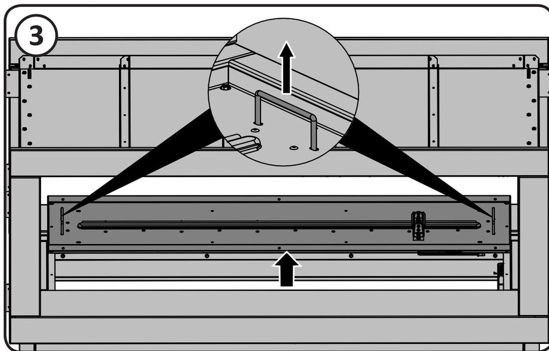
Retirez la vis (N570-0008) du couvercle du boîtier électrique.
