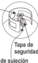
Válvula del tanque de gas
