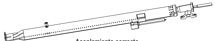
Acoplamiento correcto del quemador con la válvula
