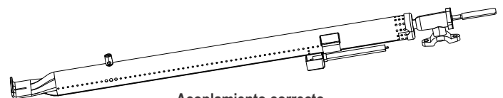
Acoplamiento correcto del quemador con la válvula
