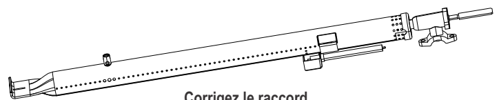
Corrigez le raccord brûleur-à-valve.
