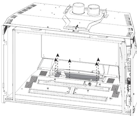
3. Retirez les 5 vis servant à fixer la plaque de recouvrement en place. Glissez la plaque de recouvrement vers l'arrière puis sortez.
