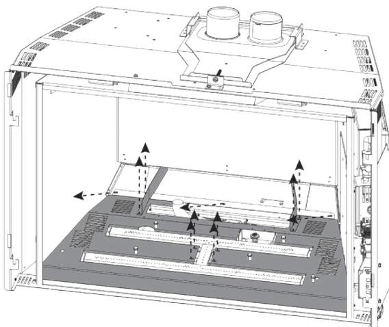
5. Retirez les 7 vis servant à fixer le support inférieur de brûleur en place. Retirez les 4 vis servant à fixer les déflecteurs en place, puis retirez les déflecteurs. Soulevez le support inférieur de brûleur vers le haut puis sortez.
