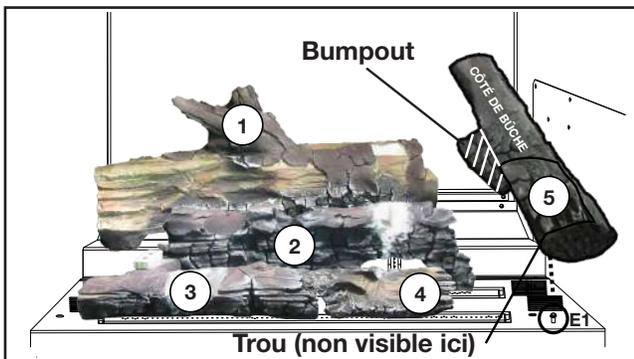
5. Placez le bumpout dans bûche n° 5 contre le support supérieur de brûleur, et le trou dans bûche n° 5 sur E1. Bûche n° 5 **doit** être très proche à la bûche n° 1 et bûche n° 4.
