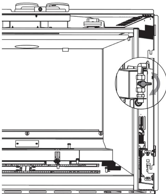
La soupape d'arrêt est dans position OFF lorsque la poignée est horizontale (voir l'illustration).
