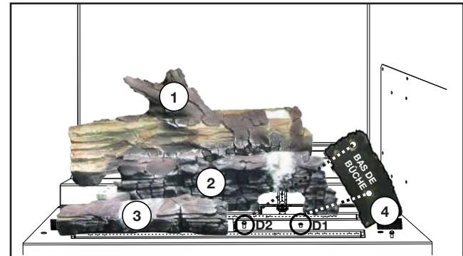
4. Placez les trous dans bûche n° 4 sur D1 et D2. Ne couvrez pas les orifices de brûleur.
