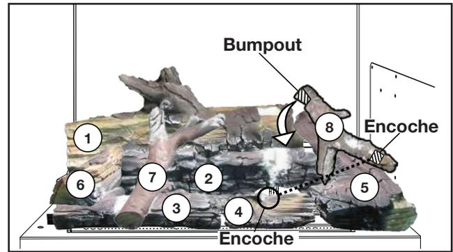
8. Accrochez le bumpout dans bûche n° 8 à l'arrière de bûche n° 2. Placez l'encoche dans bûche n° 8 sur l'encoche de bûche n° 4.
