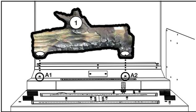
1. Placez les deux trous dans bûche n° 1 sur A1 et A2. Ne couvrez pas les orifices de brûleur.
