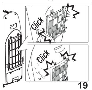
Para mantener la eficiencia del aparato se aconseja cambiar el panel evaporador cada año.
