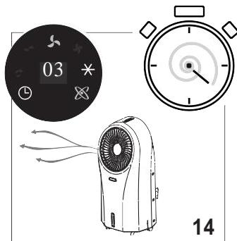
Para salir del autoapagado, pulse la tecla (B6 o D3) hasta configurar el valor numérico "00": el símbolo y "00" parpadean. Cuando se apagan, el autoapagado se cancela.
