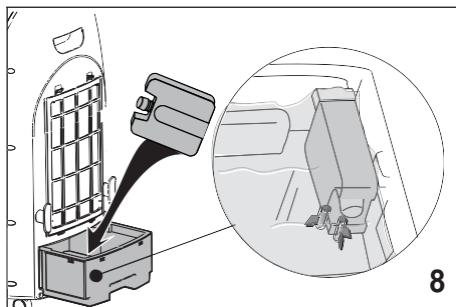
7. Vuelva a meter el depósito de agua, encienda el aparato y seleccione la función "Enfriamiento/Humidificación": el aire emitido por el aparato será más fresco (fig. 9).
