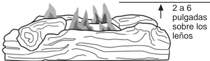
Fig. 29 - Patrón correcto/normal de la llama con llamas cortas
