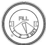
Tourner le régleur à flèche à l'intérieur du distributeur pour modifier le réglage de l'agent de rinçage.
